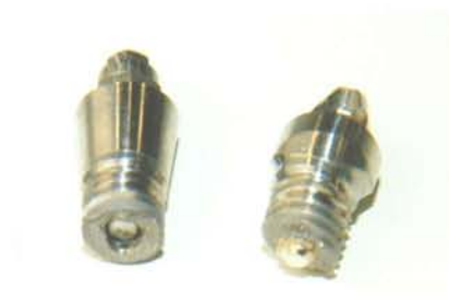
図23 アバットメントスクリーウの先端の部分でインプラントが破折することが多い。
