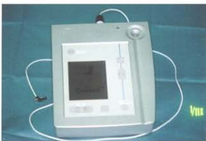
図28-a Osstellを用いて初期固定を測定。
